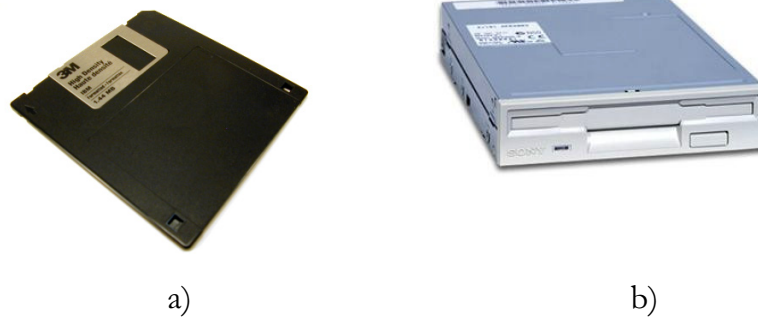
Fig. 2 – a) Disquete de 3.5 polegadas; b) Leitor de disquetes de 3.5 polegadas.
